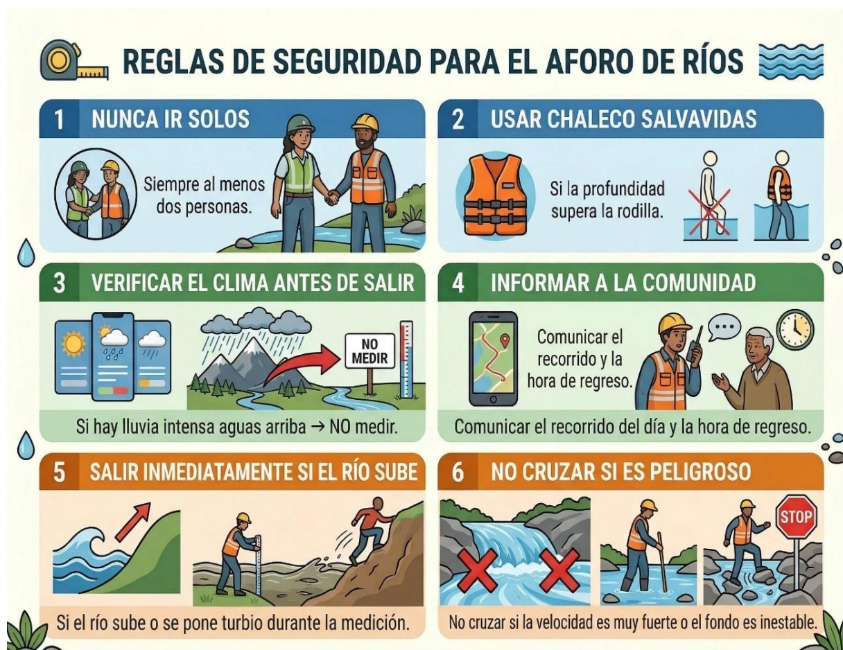
Gráfico 9. Reglas de seguridad a tomar en cuenta para la medición del aforo.
