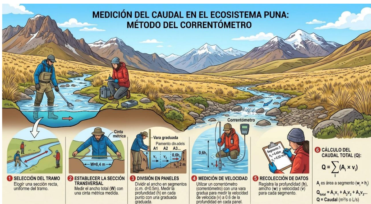
Gráfico 10. Instalación de la sección transversal para la medición de caudal.
