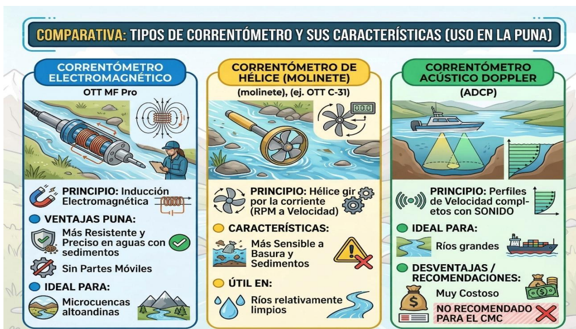
Gráfico 3. Tipos de Correntómetro y sus Características
