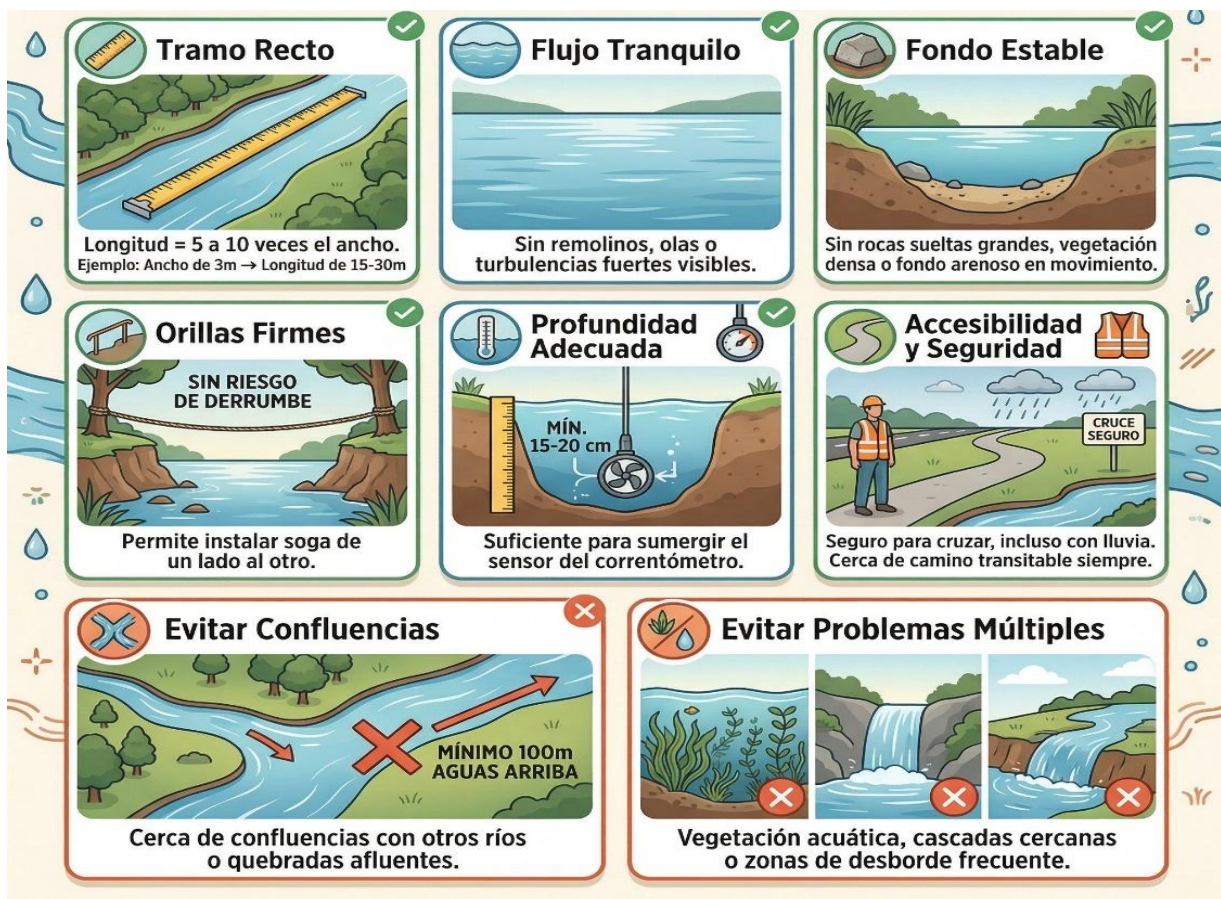
Gráfico 5. Criterios para seleccionar la sección de aforo
