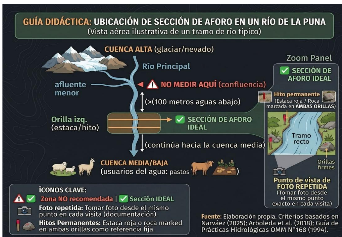
Gráfico 6. Mapa esquemático de ubicación de sección de aforo
