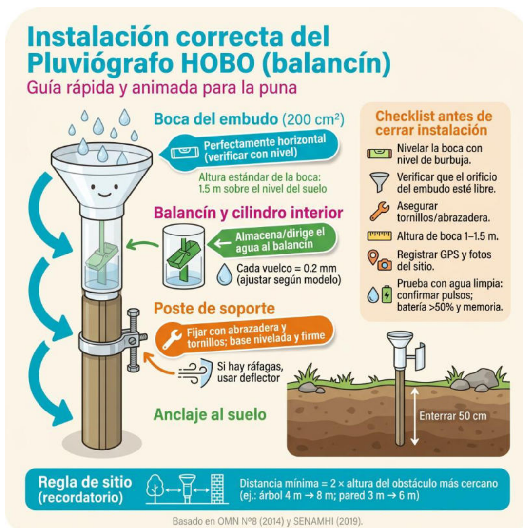
Gráfico 10. Instalación correcta de pluviografo HOBO
