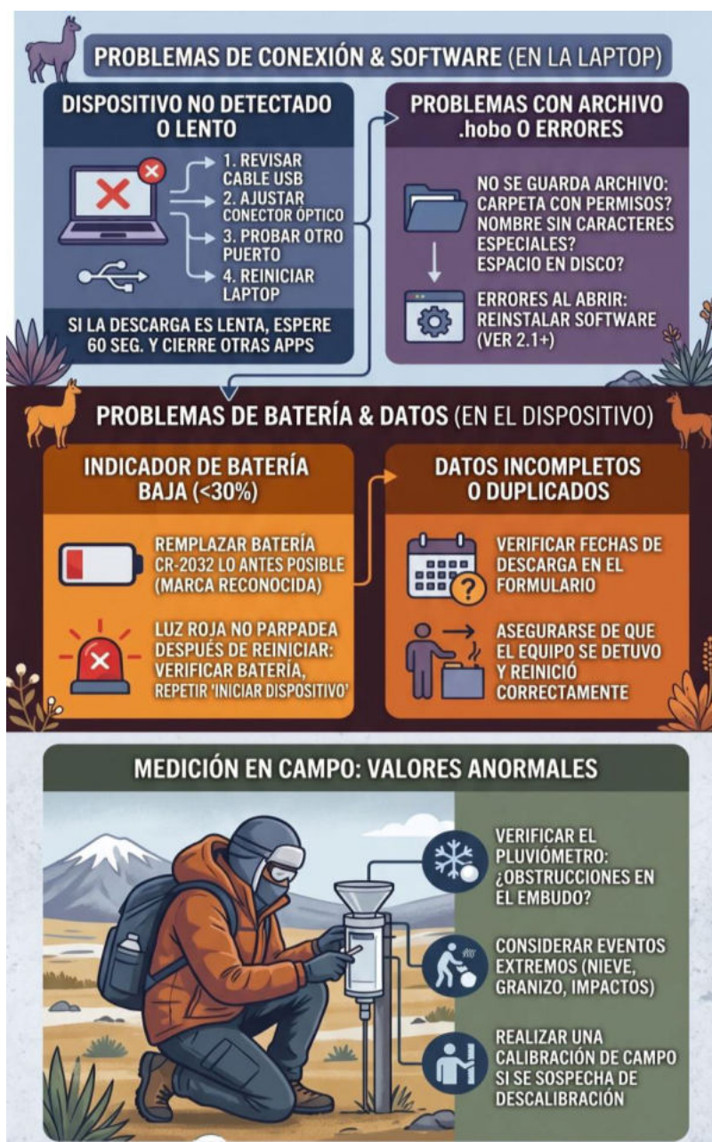
Gráfico 22. Proceso de solución de problemas para pluviógrafo HOBO.
