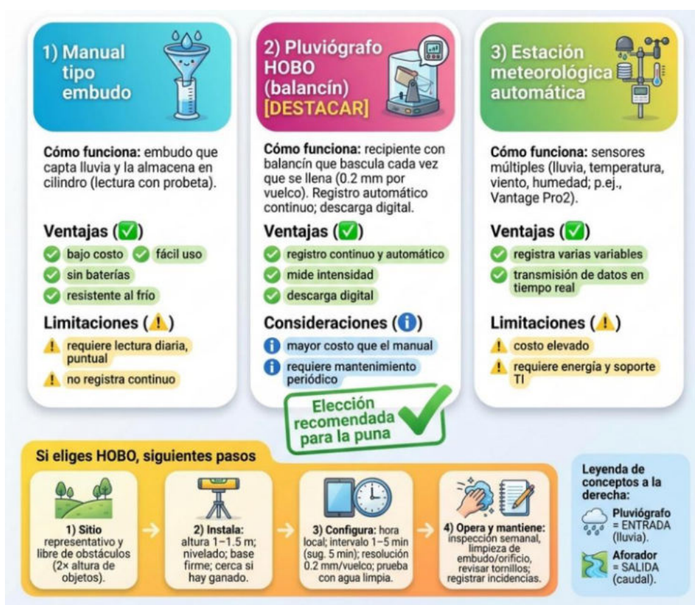
Gráfico 4. Comparativos de pluviómetros – recomendación a usar en el ecosistema Puna.
